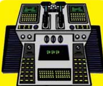
دستگاه فرمان و کنترل موتور: شامل اهرم‌های تنظیم قدرت موتور، دور موتور و تنظیم مقدار هوایی که با سوخت مخلوط می شود.
