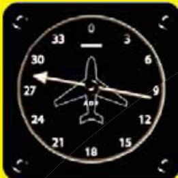
جهت‌یاب: جهت‌یاب در حقیقت یک قطب‌نمای بسیار دقیق است. این دستگاه نشان می‌دهد که هواپیما به کدام جهت می‌رود.
