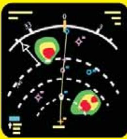
نمایشگر رادار: این سیستم، ارتفاع پرواز را اندازه‌گیری می‌کند. این سیستم در موقع لازم به خلبان اخطار می‌دهد که هواپیما در ارتفاع خیلی پایین در حال حرکت است یا در مسیر حرکت آن مانعی وجود دارد.
